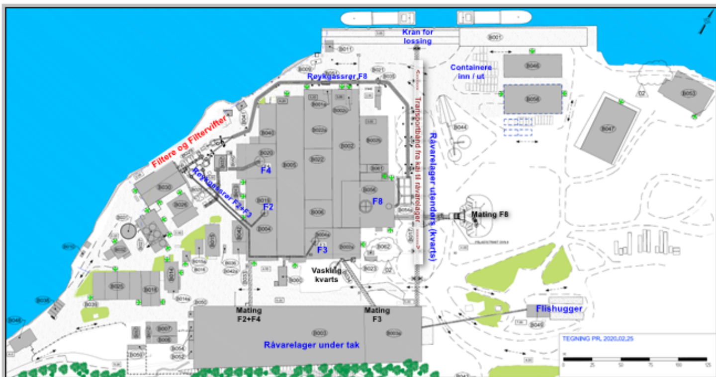
Figur 6 Dagens situasjon med avmerking av sentrale funksjoner og områder med støykilder, vist med rød og blå skrift.
