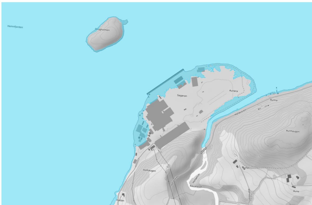
Figur 4 Eksisterende situasjon under en 200 års stormflo inkludert havnivåstigning i 2090 [2]. Deler av området nærmest sjøen risikerer oversvømmelse. Figuren tar ikke hensyn til tilleggseffekten fra bølger.
