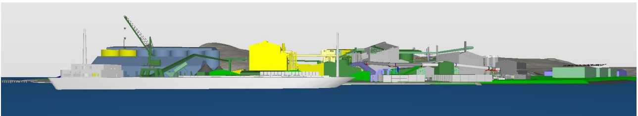
Figur 5-6 De nye smelteovnene (gule høye bygg ca midt i illustrasjonen) har samme høyde som dagens smelteovner (gråe bygg), med høyde kote +55. Foran denne skal det etableres ny kai. På lagunen (til venstre i bildet) skal det etableres ny industrivirksomhet opp til kote +60. Det er planlagt ny arbeidskai lengst til venstre i illustrasjonen. Sett fra vest vil de nye store anleggene medføre en vesentlig endring på skalaen til industrianleggene i forhold til dagens situasjon
