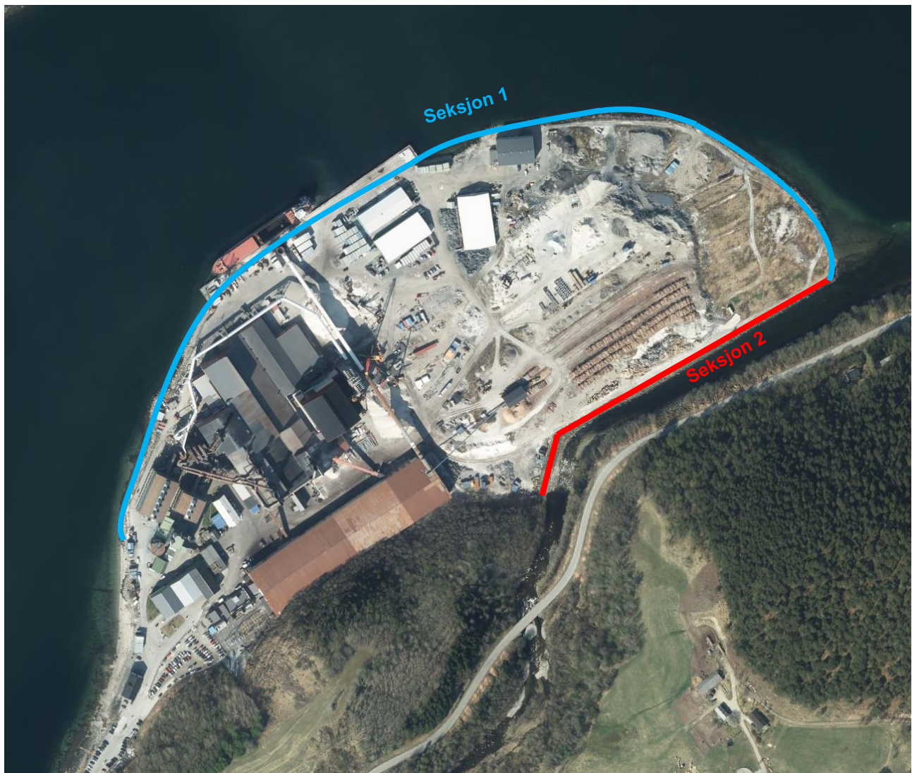
Figur 7 Erosjonssikring delt i 2 seksjoner
